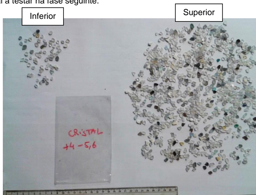
Figura 4-4- PS "cristal" com calibre +4-5,6mm no produto superior (à direita) e inferior (à esquerda) dos ensaios no Recglass com ângulo com a horizontal de 15^\circ , velocidade 0,075m/s e altura de alimentação de 16cm.
