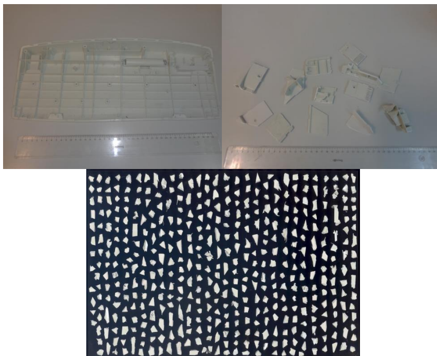
Figura 3-1: Etapas da diminuição de calibre - peça original (superior esquerda), após fragmentação manual (superior direita) e após trituração com o moinho de lâminas Retsch RM 2000 (inferior).
